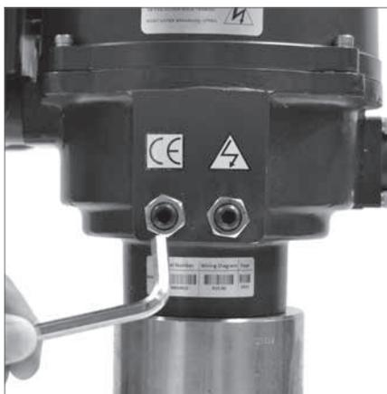
*Réglage dans le sens antihoraire pour fermer le boulon de butée*
