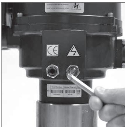
*Réglage dans le sens horaire pour fermer le boulon de butée*
