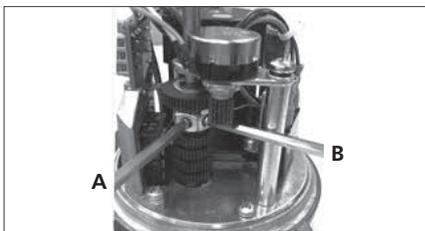
Photo D: Le mouvement du point A au point B est d'environ 60 degrés
