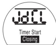
**ПРИМЕЧАНИЕ:** Инструкции [JC] и [JO] предназначены для работы таймера вокруг Закрытого положения. Для работы таймера вокруг Открытого положения, читайте останов вместо запуска [JC] и запуск вместо останова [JO].
