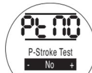
Появится опция - отменить или подтвердить завершение испытания частичного хода.
