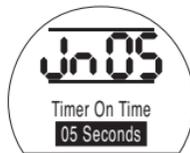
Параметр [Jn], установленный на 05, дает длительность импульса включения таймера прерывателя 500 мс или 5 секунд, в зависимости от того, как установлен параметр [JS], [OF] или [On].
