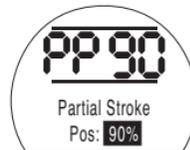
Эта функция выполняет частичный ход привода, а также регистрирует положение и внутреннее гидравлическое давление относительно времени в направлении открытия и закрытия. Это следует проводить, когда привод был только что введен в эксплуатацию на месте. Используя Insight II, его потом можно сравнить с последующими испытаниями, проведенными позже.
