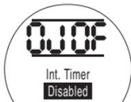
При наличии опции таймера можно получить дополнительную серию настроек, нажав кнопку
