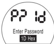
*Настройки функций привода могут быть защищены использованием пароля*
