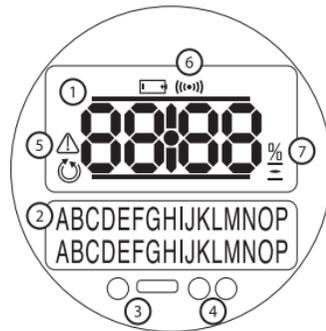
Рис. 3.2 Дисплей привода
