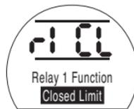
Этот экран отображается, только если функция реле установлена как [Po] Положение % Открытия и [tt] Температура (°C).
