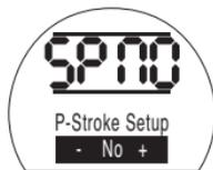
Появится опция - отменить или подтвердить завершение первого контрольного испытания частичного хода.
