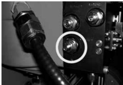
Для вашего привода ЕН можно указать дополнительное ручное управление. Для всех приводов ЕН, дополнительное ручное управление обеспечивается гидравлическим ручным насосом. При поставке насос со съемной ручкой находится на устройстве питания или рядом с ним.
