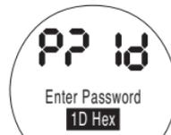
*Дисплей пароля, Режим проверки*
