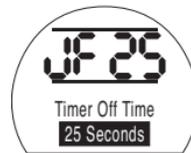
Параметр [JF], установленный на 25, дает длительность импульса отключения таймера прерывателя 2500 мс или 25 секунд, в зависимости от того, как установлен параметр [JS], [OF] или [On].
