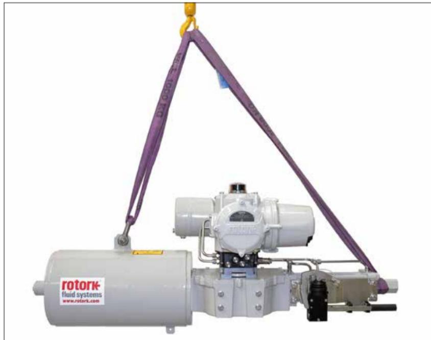
Fig. 4.1.1. Eslingas acopladas a la lengüeta de izado y a la cubierta del tope mecánico del cilindro hidráulico
